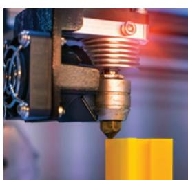
압출을 통해 작동하는 Fused deposition modeling printer도 막힘을 방지하기 위해 압출기 노즐(extruder nozzle)을 청소해야 합니다. 노즐의 외관부는 아직 뜨거운 상태에서 필요하다면 세척액에 적신 천을 사용하여 세척할 수 있습니다. 이러한 세척으로 충분하지 않다면, 와이어 브러시, 작은 칼날 또는 바늘 등을 사용할 수 있습니다.
