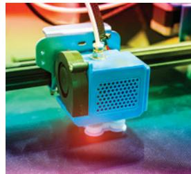
3D 프린터의 프린터 베드(printer bed)는 일반적으로 폴리에테르이미드(PEI, polyetherimide) 시트, 유리 또는 접착 테이프(non-heated bed에 사용되는)로 구성됩니다. 정기적으로 세척하면 결함이 발생할 가능성을 최소화할 수 있습니다.
